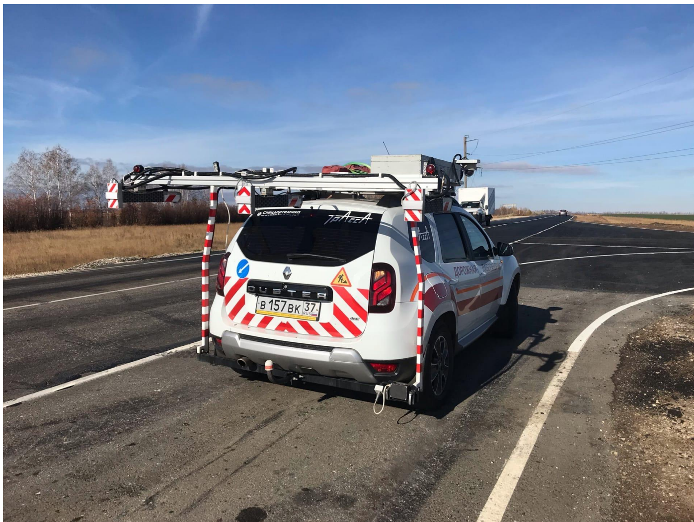
Рис. 1. Комплекс измерительный передвижной дорожной лаборатории «Трасса»
