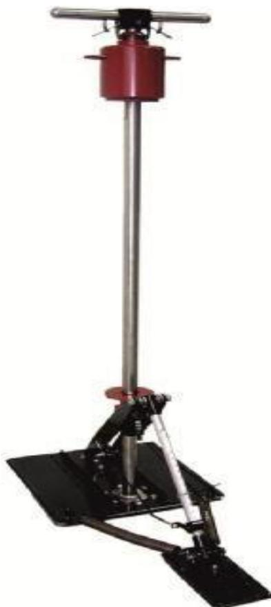
Рис. 2. Измеритель коэффициента сцепления портативный ИКСп-2М
