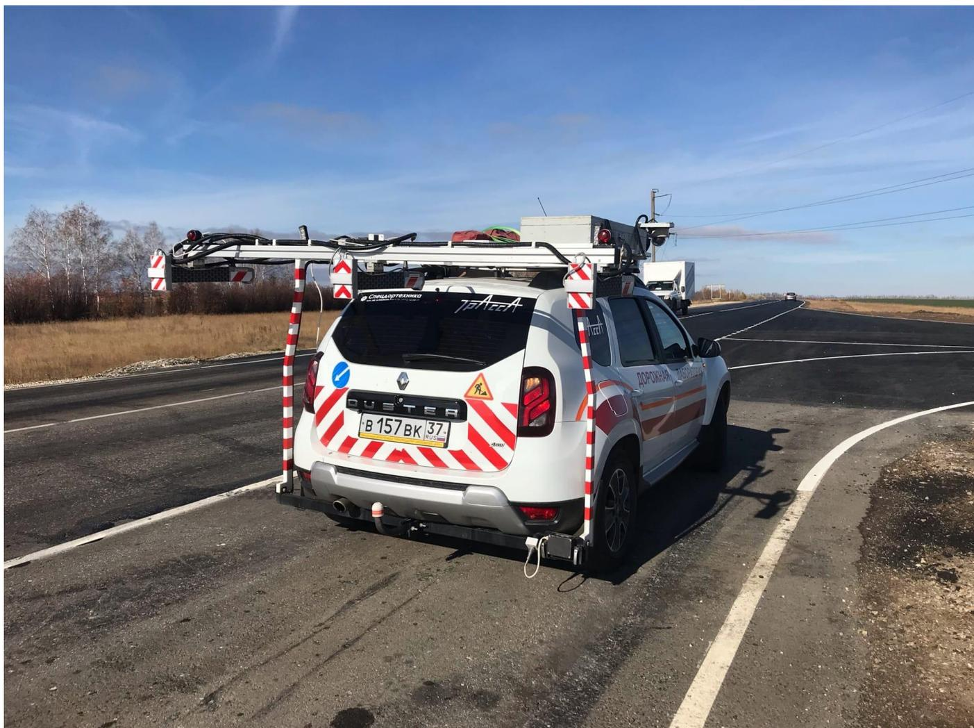
Рис. 1. Комплекс измерительный передвижной дорожной лаборатории «Трасса»
