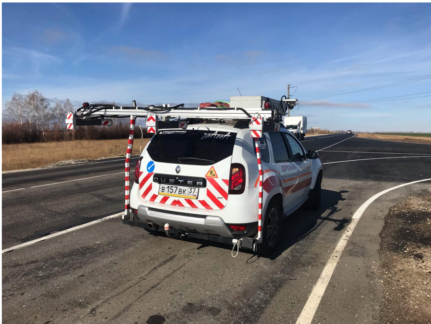
Рис. 1. Комплекс измерительный передвижной дорожной лаборатории «Трасса»
